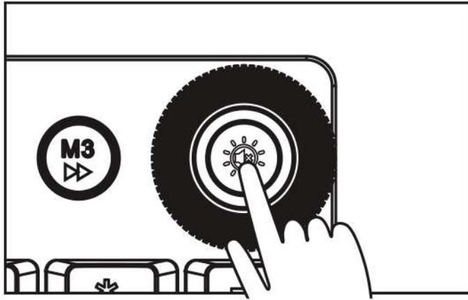
**PARA ALTERNAR ENTRE OS MODOS, BASTA SE GURAR O BOTÃO CENTRAL DO ROTARY CONTROL POR 3 SEGUNDOS.**
